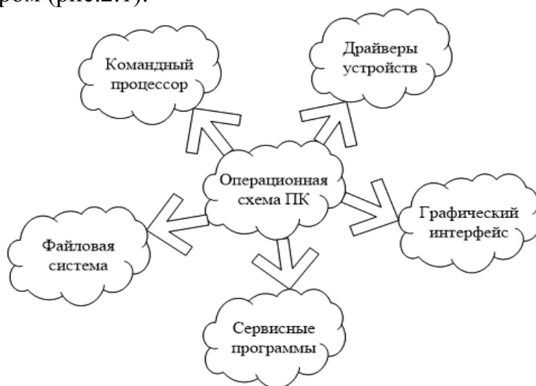
Рис.2.1. Структура операционной системы ПК
