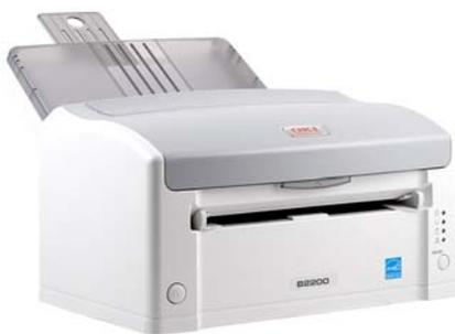
*Светодиодные принтеры.* Принцип действия светодиодных принтеров похож на принцип действия лазерных принтеров. По сути, это одно из ответвлений предыдущей, «лазерной» технологии — LED технология. Основное отличие заключается в том, что источником света является не одиночная лазерная головка, а целая линейка, состоящая из множества (от 2,5 до 10 тысяч штук) светодиодов.
