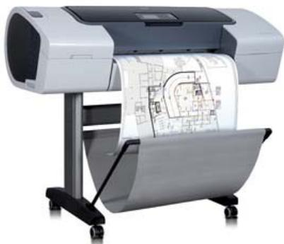
*Плоттер* или *графопостроитель* (от греч. γράφω – пишу, рисую) используется, в основном, для вывода с большой точностью графической информации – чертежи, схемы, диаграммы, карты, большие рисунки и т.п. на бумагу.
