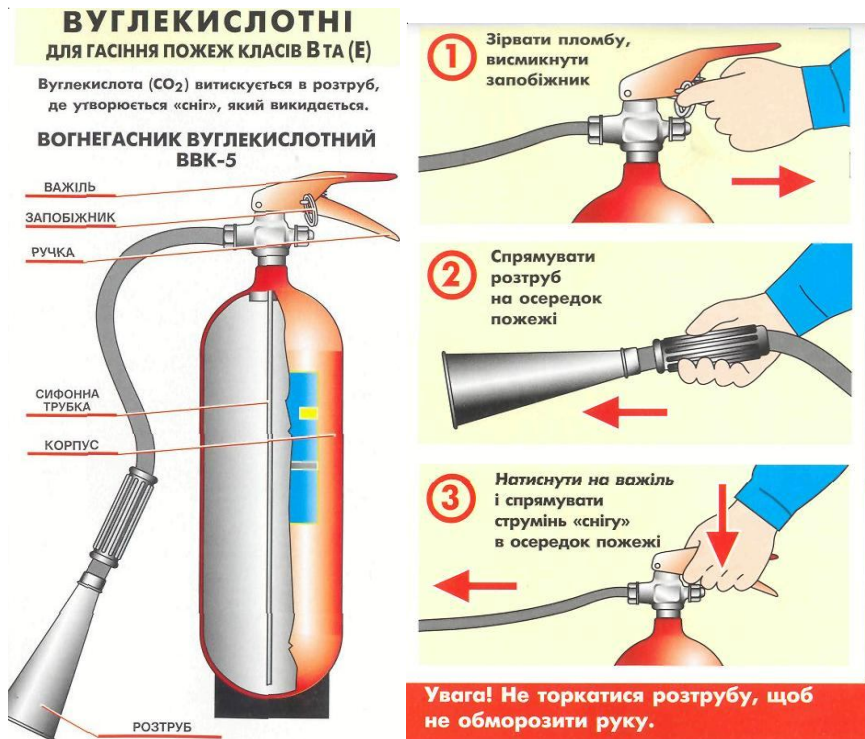
Рис. 15. Вуглекислотні вогнегасники та порядок приведення їх у дію
