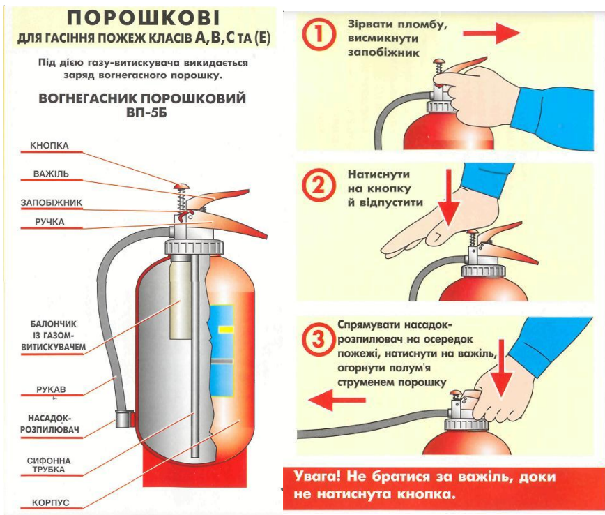
Рис. 16. Порошкові вогнегасники та порядок приведення їх у дію
